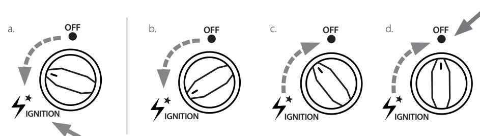
a.) Den Brenner zünden, indem Sie den Regler gegen den Uhrzeigersinn in Zündrichtung drehen, bis er hörbar einrastet. Das Klicken stellt die Zündung dar. Der Brenner sollte jetzt zünden.
