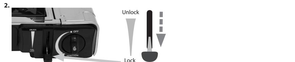
Wenn die Gaskartusche eingesetzt ist, fahren Sie fort: Schieben Sie den Verriegelungshebel nach unten in die Verriegelungsposition.
