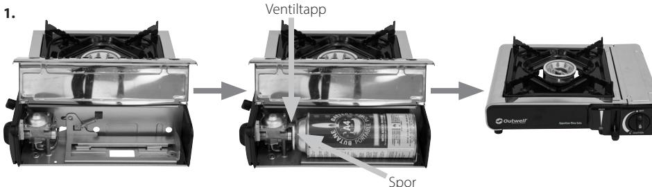
Åpne rommet for gassbeholderen slik at du kan sette inn beholderen.
