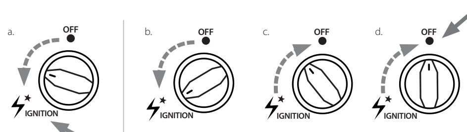
a.) Hořák zapálíte otáčením ovládacího knoflíku proti směru hodinových ručiček směrem k nápisu IGNITION, dokud neuslyšíte cvaknutí. Cvaknutí značí zapálení hořáku.
